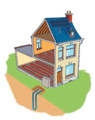
**Sol/ Sol** : dans ce cas précis (détente directe) le fluide frigorigène passe de l'évaporateur (tuyau souterrain dans le terrain) vers le plancher chauffant de la maison directement.
