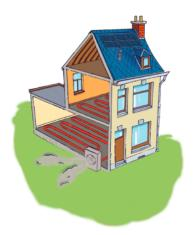
Air/ Eau : il s'agit du système le plus couramment utilisé. Les calories sont puisées dans l'air extérieur via un fluide frigorigène et restituées dans l'eau via un chauffage par le sol, par exemple.
