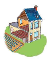
Sol/ Eau : les calories sont puisées dans le sol ( par un fluide frigorigène parcourant le jardin) et restituées dans de l'eau par un plancher chauffant.
