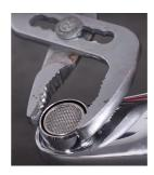
Le mousseur est constitué de plusieurs filtres. Son rôle est d'infuser de l'air dans l'eau qui coule. Il n'y a pas de perte de débit pour autant !
