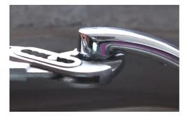
Identifier les trois parties du mousseur (le joint – le filtre et la bague) et constituer le correctement.
