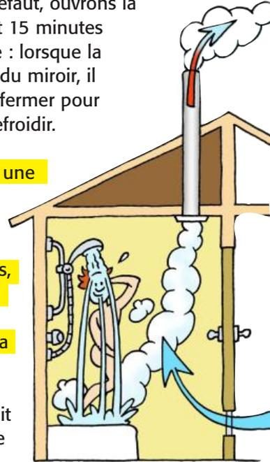
Veillons à ne pas la choisir trop puissante : elle risquerait d'inverser le tirage d'un poêle installé dans la même pièce.
