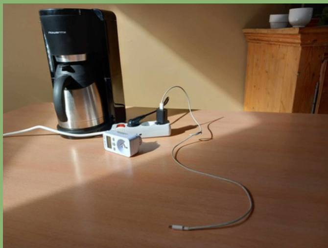
Mesure des consommation Utilisation de wattmètres
